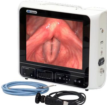
Представляет собой комбинацию камеры, источника света и монитора. Благодаря портативному дизайну видеосистема удобна для транспортировки, что позволяет легко ее перемещать между кабинетами или использовать в машинах скорой помощи, передвижных медицинских пунктах.
